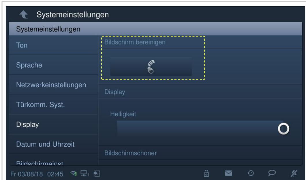
Auf dem Bildschirm wird ein Countdown (1...30) angezeigt. Sämtliche Vorgänge auf dem Bildschirm werden außer Kraft gesetzt. Das Gerät verlässt den Modus "Bildschirm bereinigen", wenn ein Ruf eingeht.
