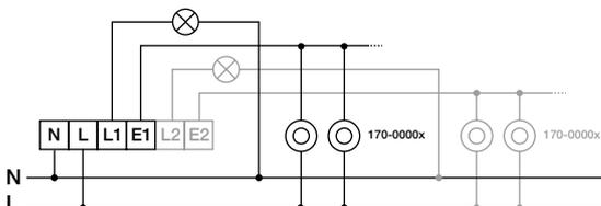
Connectez les contacts du bouton-poussoir classique à la borne L et à la borne E1 de l'interrupteur intelligent.
