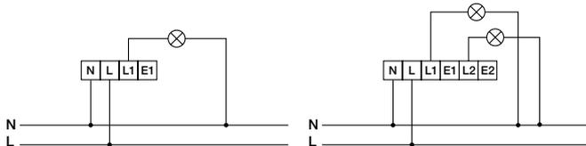
Po pripojení bude smart switch fungovať ako normálny spínač
