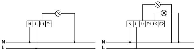
Nach dem Anschluss funktioniert der Smart-Schalter wie ein normaler Schalter.
