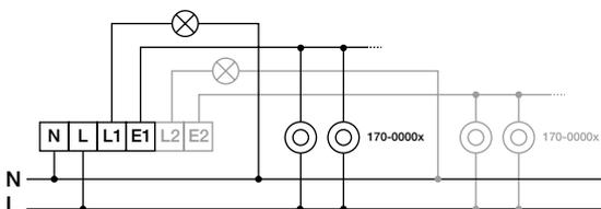
Sluit de contacten van de klassieke drukknop aan op de L-klem en E1-klem van de slimme schakelaar. Gebruik klem E2 om het tweede kanaal van de slimme schakelaar (enkel geldig voor de 410-002X0) uit te breiden met klassieke drukknoppen.
