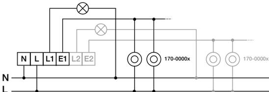
Schließen Sie die Kontakte des klassischen Drucktasters an die L-Klemme und E1-Klemme des Smart-Schalters an. Verwenden Sie die E2-Klemme, um den zweiten Kanal des Smart-Schalters (ausschließlich gültig für die 410-002x0) um klassische Drucktaster zu erweitern.
