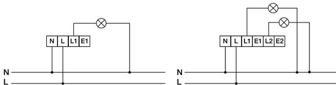
Après raccordement, l'interrupteur intelligent fonctionne comme un interrupteur ordinaire.
