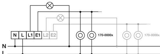
Pripojte kontakty bežného tlačidla k svorkám L a E1 (na spínači smart switch). Použite svorku E2, ak chcete rozšíriť druhý kanál spínača smart switch (platí len pre 410-002x0) o bežné tlačidlá.
